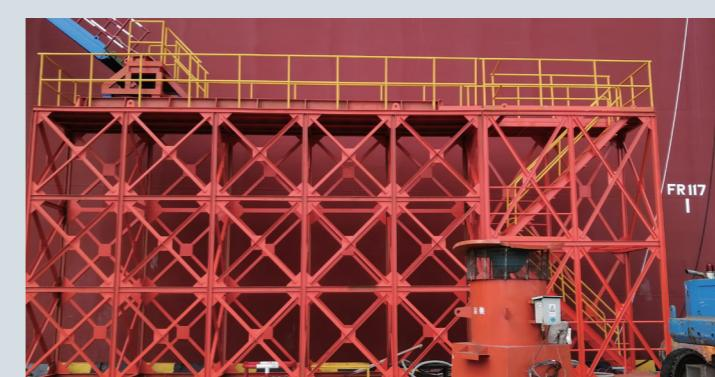
为了满足码头船舶在建过程中双通道的要求，发生紧急情况时可以有效、快速的疏散，提升公司码头区域应急疏散能力，前期安环部组织相关部门开展了登船梯工装的研究。
