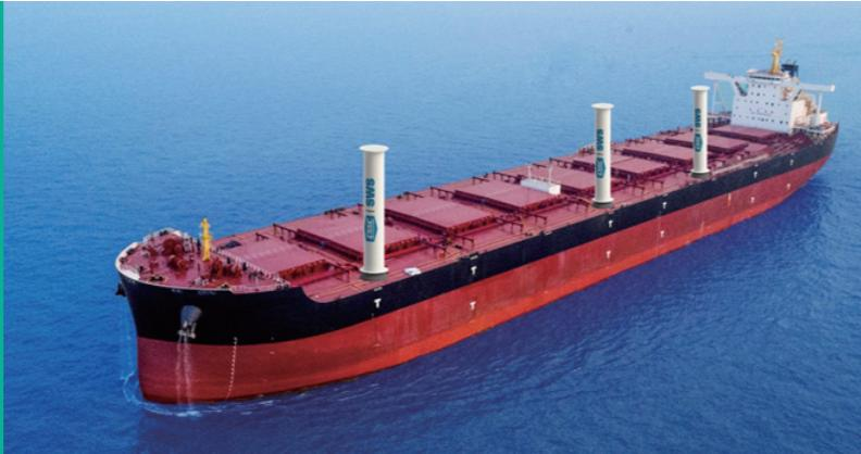
随着环保要求的日益严格，风能因其清洁、可再生、能源丰富和分布广泛的特点而再次得到航运业的关注，公司顺应潮流开发了旋转风筒辅助推进的18万吨好望角散货船。采用基于马格努斯效应的弗莱特纳转子风筒技术，结合流体力学、空气动力学以及天气预报技术，通过计算机和自动化控制技术，该船在海上航行时可借助旋转风筒助航技术直接将风能转化为辅助推进力，通过对风能的现代化利用实现船舶的节能减排。旋转风筒节能装置在该船型上的有效运用，巩固了公司在此船型在国际上的竞争力，为进一步抢占市场份额，创造更高的经济效益，提供支持。
