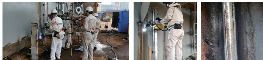
2018年9月份以来，便携式焊接机器人正式在H1465船103/134总组焊缝、H1389船10L总段555分段及H1465船舱口围施焊，焊缝成型良好，拍片质量合格，取得了预期效果，后续将继续在生产中进行应用。
